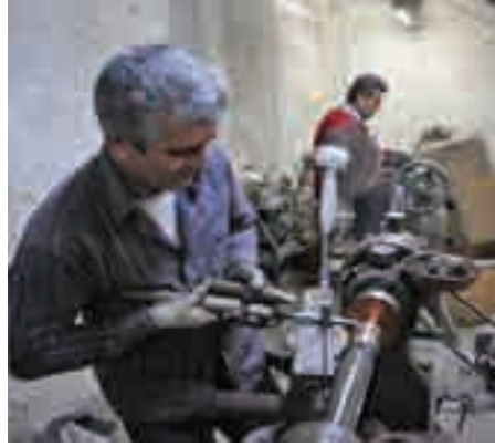
Fotoğraf 118. Bakır Pulun Dişliler Arasında Sabitlenmesi
