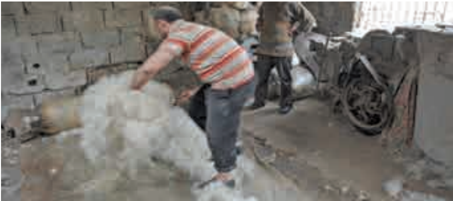
Fotoğraf 249. Sepki ile Elyafın Yayılması
