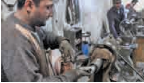
Fotoğraf 174. Cezve Kalıplarının Çıkartılması
