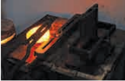
Fotoğraf 87. Pota İçerisinde Eritilen Altının Kalıp İçerisine Dökülmesi
