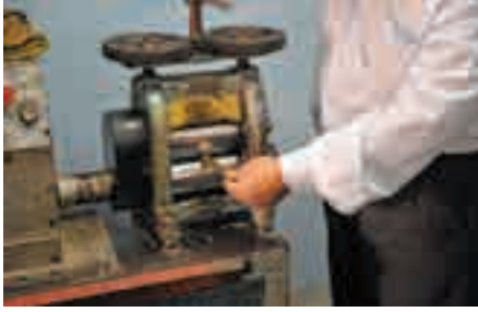
Fotoğraf 89. Silindir Haddeden Çekilen Altın Levhanın Ölçülmesi
