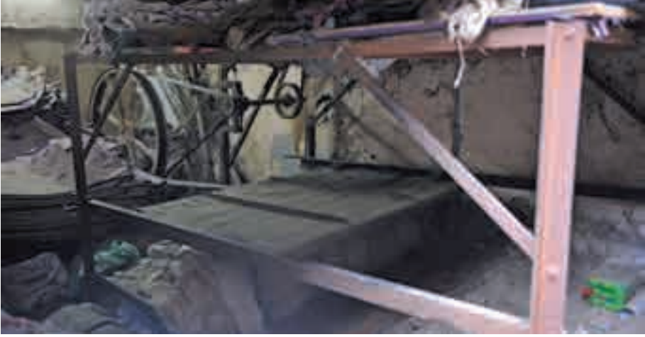
Fotoğraf 262. Kahramanmaraş'ta Kullanılan Pres (Sıkıştırma) Makinesine Keçenin Yerleştirilmiş Hali
