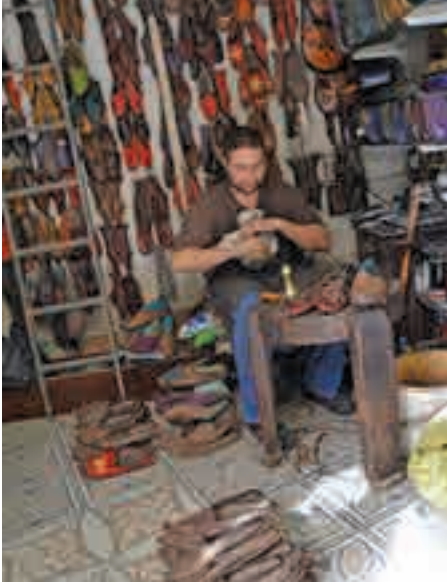
Fotoğraf 222. Dikişi Yapılan Yemeninin Kalıp Üzerinde Muşta İle Şekillendirilmesi
