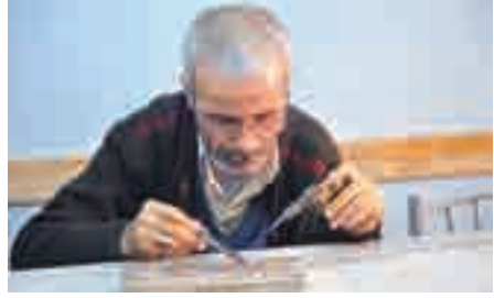
Fotoğraf 95. Şekillendirilen Parçaların Kaynakla Birleştirilmesi
