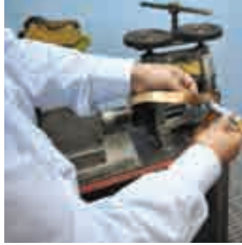
Fotoğraf 73. Mikrometre ile Astar Altın Ölçümü
