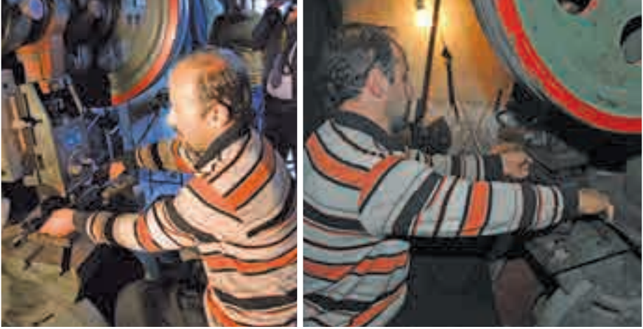
Fotoğraf 187. Çelik Şeritlerin Kesilmesi İşlemi
