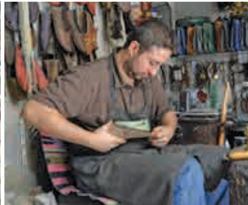
Fotoğraf 223. Şekillendirilmiş Çarığın Yanlarında Meydana Gelen Fazla-lıklarının Kesilmesi ve Kalıplanması
