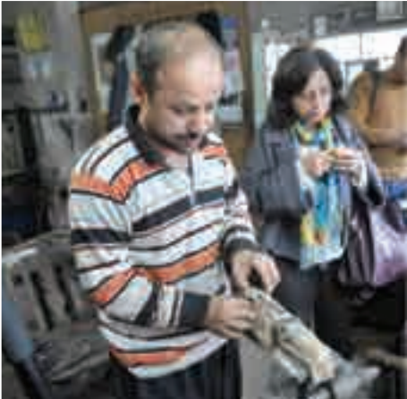
Fotoğraf 194. Mengene Üzerinde Yüksekliklerin Giderilmesi
