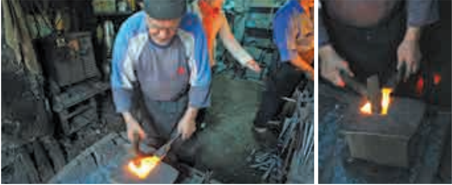
Fotoğraf 205. Kor halindeki Demirin Çekiç Darbeleriyle Şekillendirilmesi
