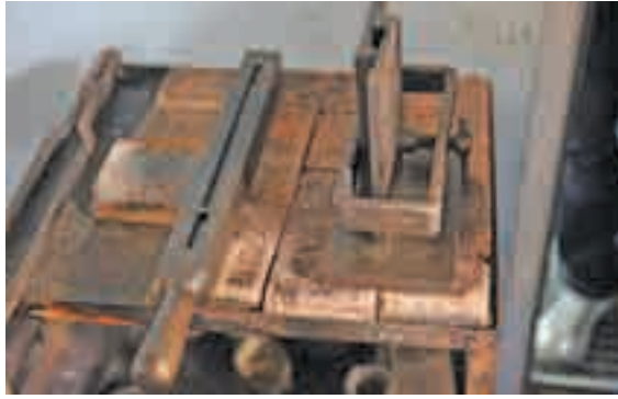
Fotoğraf 71. Maşa, Sıvı Altının Döküldüğü Şide ve Derece
