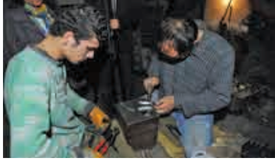
Fotoğraf 200. Teli Takılarak Perçinleme İşleminin Yapılması
