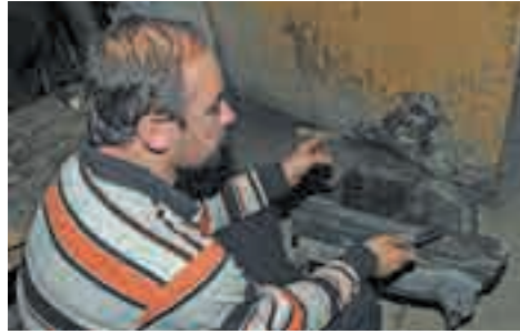
Fotoğraf 202. Bıçağın Zeytinyağı ile Tekrar Eğelenmesi
