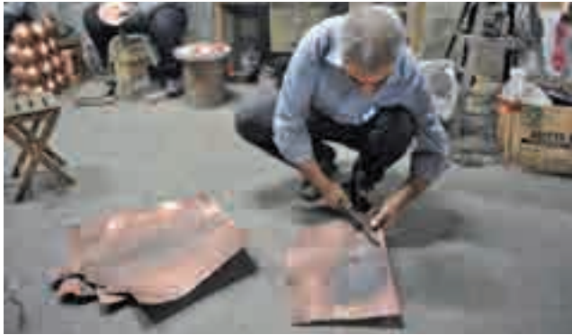
Fotoğraf 115. Bakır Levhanın Kesilmesi
