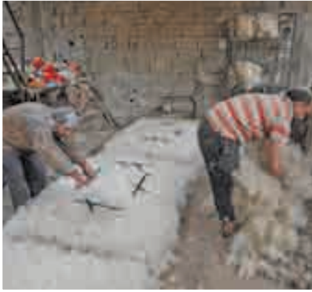
Fotoğraf 257. Elyafın Üzerine Desen (Bellik) Yerleştirme
