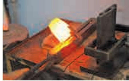
Fotoğraf 87. Pota İçerisinde Eritilen Altının Kalıp İçerisine Dökülmesi
