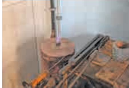
Fotoğraf 86. Altının Ocakta Eritilmesi İşlemi
