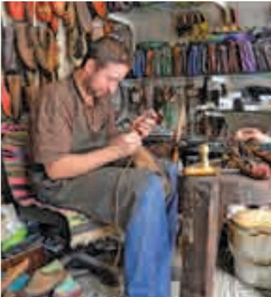
Fotoğraf 223. Şekillendirilmiş Çarığın Yanlarında Meydana Gelen Fazla-lıklarının Kesilmesi ve Kalıplanması
