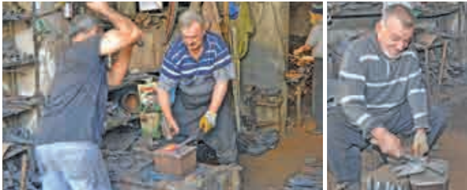
Fotoğraf 206. Tava Gelen Demirin Karşılıklı Vurulan Darbelerle Tekrar Setleştirilmesi
