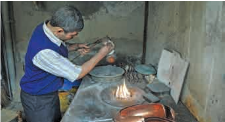
Fotoğraf 182. Fazla Kalayın Temizlenmesi
