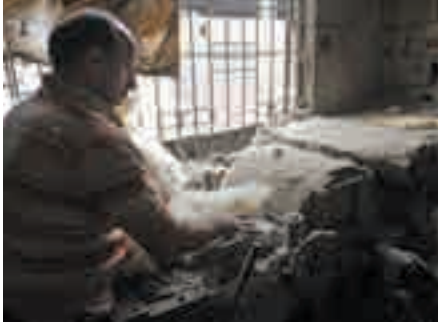
Fotoğraf 252. Yünün Hallaç Makinasında Atılması
