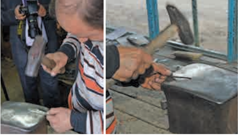
Fotoğraf 190. Çeliğin Döğülerek Sertleştirilmesi
