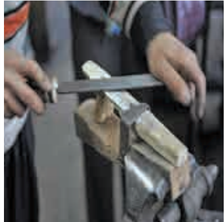
Fotoğraf 194. Mengene Üzerinde Yüksekliklerin Giderilmesi
