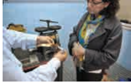
Fotoğraf 89. Silindir Haddeden Çekilen Altın Levhanın Ölçülmesi
