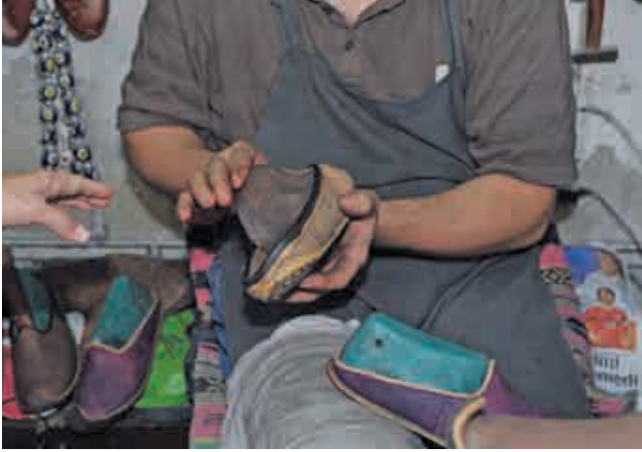
Fotoğraf 221. Taban ve Yan Parçaların Elde Birleştirilmesi
