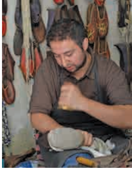
Fotoğraf 222. Dikişi Yapılan Yemeninin Kalıp Üzerinde Muşta İle Şekillendirilmesi
