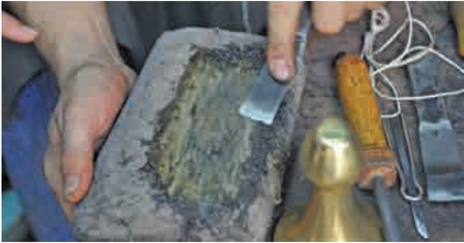
Fotoğraf 220. Biye Taşı, Bıçakları Bileylemek ve Uçlarını Keskinleştirmek İçin Kullanılmaktadır.
