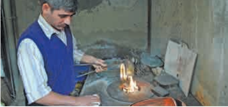
Fotoğraf 179. Bakır Ürünün Isıtılması
