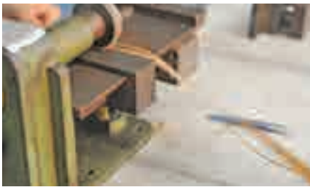
Fotoğraf 91. Altın levhanın Yapılacak Ürün Özelliğine Göre Kesilmesi İşlemi
